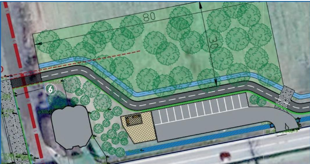
Particolare planimetrico del tracciato della pista ciclopedonale Crema-Lodi nei pressi del tempietto dei Morti delle Tre Bocche. Oltre all'area piantumata a verde, nel progetto è previsto l'area sosta attrezzata (in giallo), e l'area parcheggio (in grigio).dal tetto della sala cine.
