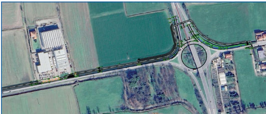
Particolare planimetrico del tratto della pista ciclopedonale Crema-Lodi ricompreso tra i Morti delle Tre Bocche e l'abitato di Ombriano. In prossimità della tangenziale il tracciato ciclabile la sottopassa a raso in lato di tramontana della rotonda.
